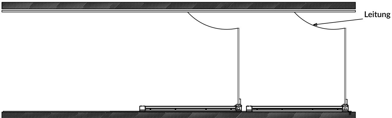
Die Stromzufuhr erfolgt über ein Schleppkabel mit Leitung
